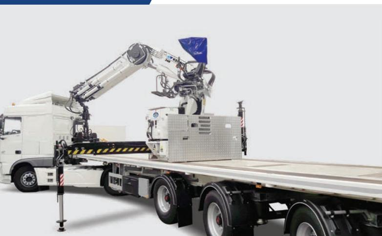
Utilisée pour des éléments standards tels que des barrières routières, elle peut être équipée en option d'un bras stabilisateur hydraulique extensible et de pieds stabilisateurs inclinables.
