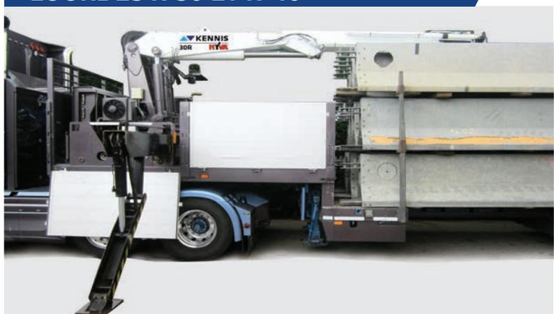
Grues roulantes pour charges lourdes R-30 et R-40 ont une portée allant jusqu'à 12 mètres pour soulever et placer de manière précise des éléments très lourds tels que des panneaux de plancher en béton, des tuyaux d'égouts ou encore des poteaux en béton, par exemple.
